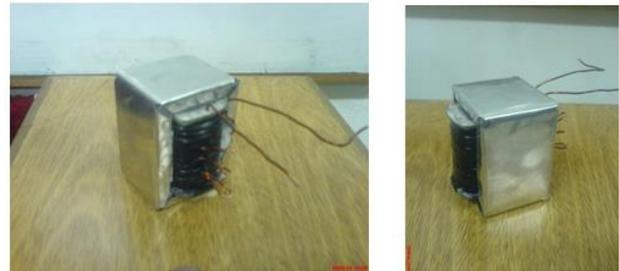
Figura 10 Fotos del transformador diseñado y construido, listo para ser acoplado al mango del pirógrafo
